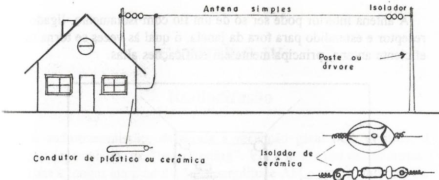
*Antena em T* — o desempenho desta antena pouco difere da antena em "L" invertida. Na realidade sua colocação entre este ou outro tipo, depende exclusivamente das facilidades de instalação. É ligado um único fio do centro da antena ao receptor.
