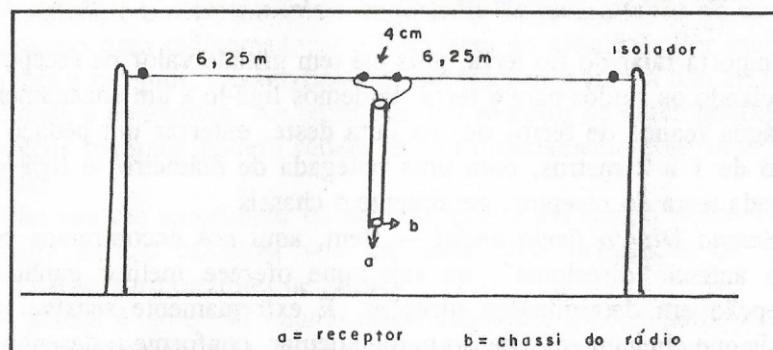
Como exemplo, para calcularmos seu comprimento físico para receber sinais da faixa de 25 metros, dividimos esta por dois, resultando 12,5 metros, colocando 6,25 metros para cada polo, e ligamos os dois fios do cabo coaxial no centro, com afastamento de 4 a 8 centímetros.
