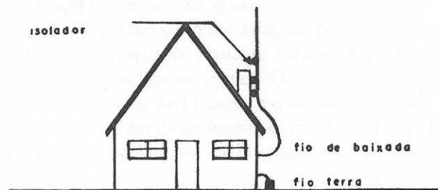
O fio que une a antena propriamente dita com o receptor se chama "baixada", recomendando-se o uso de cabo blindado (coaxial), cuja malha exterior se ligará à terra (chassis do receptor). Poderá, também, ser ligado um fio flexível comum, isolado, nº 14, sem a vantagem do cabo coaxial, pois a proteção da malha evita a captação de ruídos nas proximidades, tais como ignição de carros, tomadas elétricas, motores, etc.
